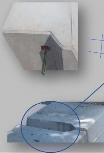
Al fine di consentire la rotazione i manufatti sono dotati di riseghe laterali nella parte retrostante di cm 7,5 che permettono la realizzazione di curve aperte o chiuse con massimo raggio pari a cm. 270 (misurabile sulla sommità del muro - curva aperta) e la possibilità di fuoriuscita dell'attrezzatura utilizzata per il sollevamento e posizionamento del blocco (fasce, catene, etc....).
