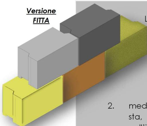
I blocchi verranno disposti a corsi paralleli con lo sfalsamento di mezzo blocco - effetto muratura. È previsto per la partenza ed arrivo il mezzo blocco.
